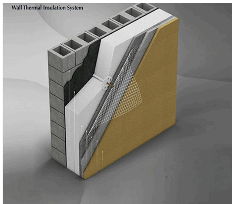
وفي هذا النظام يتم تغليف المبني تماما بمادة العزل المناسبة بهدف تقليل الانتقال الحراري من وإلى المبني لأقصى درجة ممكنه والهدف هو تحقيق كود العزل الحراري السعوي للجدران الخارجية  $0.342 \text{ W/m}^2\cdot\text{K}$  الذي يتم تحقيقه بالتحكم في سماكة مادة العزل .
